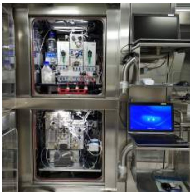
Capela de fluxo laminar blindada (Hotcell) de duas portas que é utilizada na produção do PIB- 11 C. Dentro da hotcell está o módulo de síntese Eckert & Ziegler: Porta inferior, módulo gasoso, onde o carbono-11 está na forma de gás. Porta superior, módulo de metilação, onde a marcação da molécula acontece
