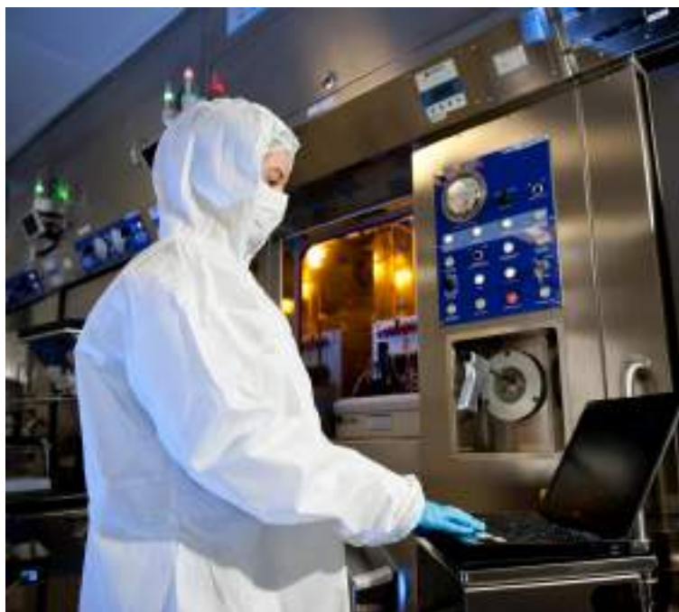
Dentro das hotcells há um sintetizador automatizado para a produção do radiofármaco que é comandado por um software e o farmacêutico deve fazer a programação do funcionamento conforme o radiofármaco a ser produzido
